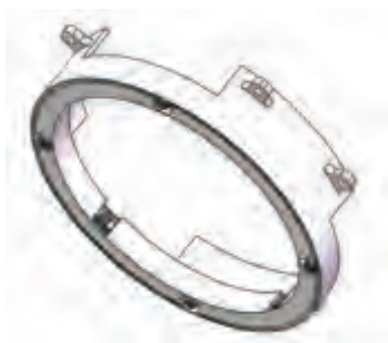
一体化结构（集成4路轴向测量和4路径向测量）
