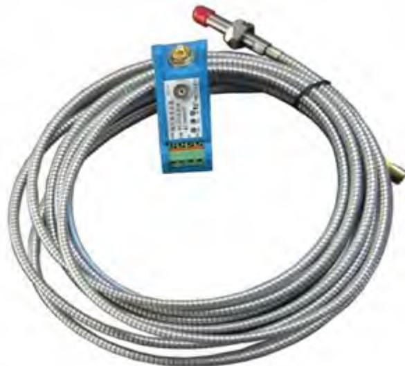
如上图，JX5131XL 转速变送器由探头和变送器两部分组成，探头允许带延伸电缆，但其总的电气长度要与变送器型号标明的电缆长度一致。
