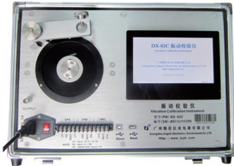
DX-02C振动校验仪是在DX-02基础上升级的全智能振动校验仪,可校准多种类型的振动传感器,如加速度传感器、振动速度传感器及电涡流式位移传感器,也可对由上述传感器所组成的各种振动测试仪表、振动监测系统及数据采集系统进行校准。
